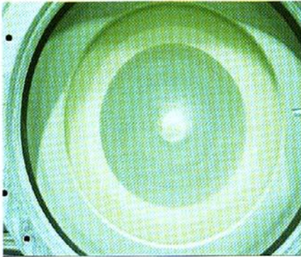
▲ Abb. 3: Sedimentation des festen Produktanteils im Flüssigkeitsring
