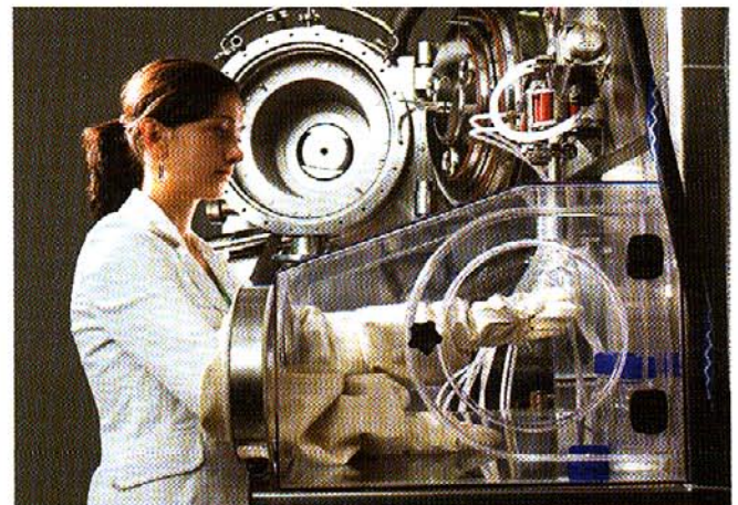
▼ Abb. 10: Zentrifugentrockner mit Probenentnahme als High-Containment Ausführung
