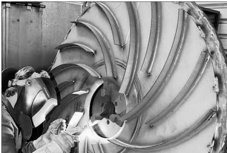
Ein Fima-Mitarbeiter schweißt Schaufeln auf eine runde Metallplatte, um so die Baseinheit für das Laufrad im späteren Ventilator zu fertigen. Foto: Grill
